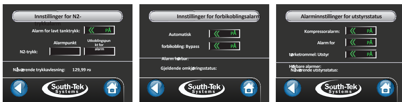
Figur 33: Skjermbilder for alarminnstillinger for N2-trykk, bypass og utstyrstatus
